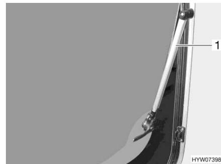
Fig. 71 Ventana abatible con soporte automático
