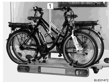
Fig. 5 Disposición de bicicletas eléctricas
