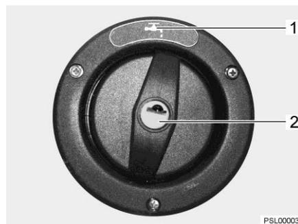
Fig. 45 Tapa de cierre para el tubo de llenado de agua potable
