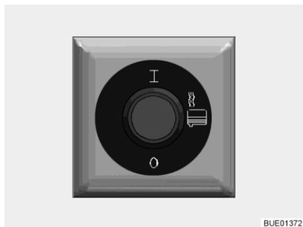
Fig. 174 Interruptor para calefacción de aguas residuales
