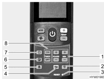
Fig. 151 Mando a distancia con teclas de ajuste (instalación de aire acondicionado)
