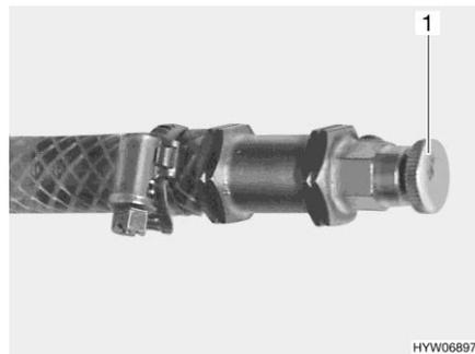
Fig. 187 Válvula de purga de la calefacción de agua caliente
