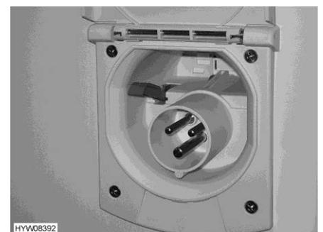
Fig. 123 Conexión de 230 V en el vehículo
