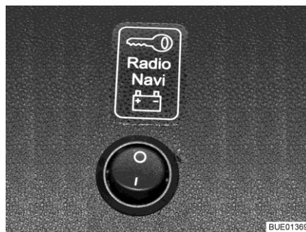
Fig. 118 Conmutador selector de alimentación de corriente
