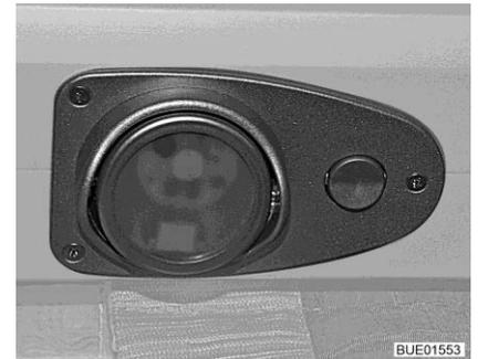
Fig. 193 Lámpara de LED con interruptor
