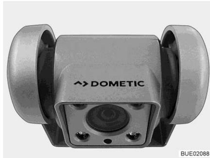
Fig. 14 Cámara de marcha atrás con LED infrarrojos
