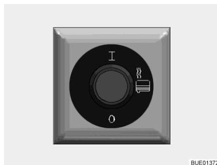
Kuva 174 Kytkin jäteveden lämmitykselle
