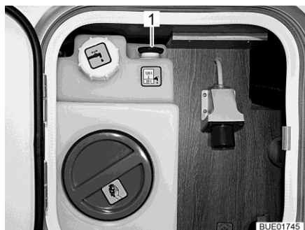
Fig. 279 Depósito de agua (unidad de servicio)
