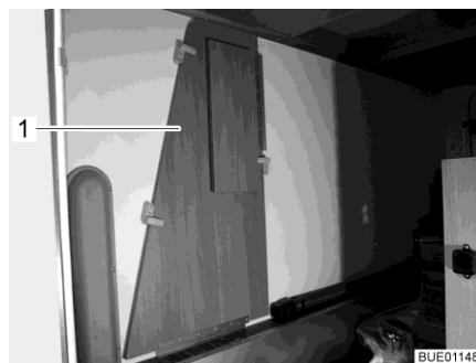
Fig. 12 Ensanchamiento de cama en el garaje trasero
