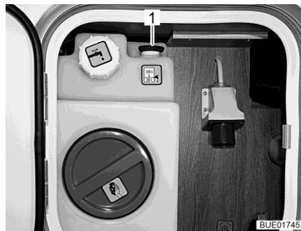
Fig. 277 Depósito de agua (unidad de servicio)
