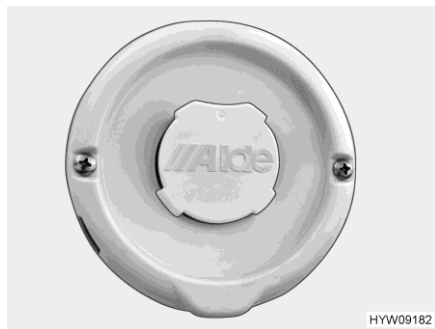
Fig. 242 Tubo de chimenea en la pared (calefacción de agua caliente)
