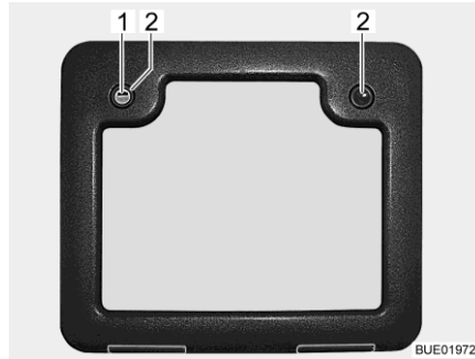
Fig. 291 Trampilla para el depósito de aguas fecales (alternativa)
