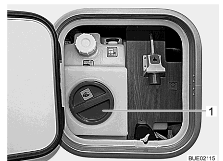
Fig. 307 Orificio de limpieza del depósito de agua (unidad de servicio)
