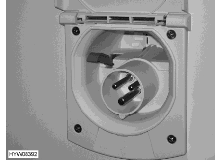
Fig. 208 Conexión de 230 V en el vehículo (sin unidad de servicio)
