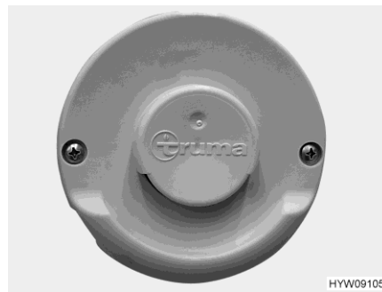
Fig. 243 Tubo de chimenea en la pared (calefacción de aire caliente)
