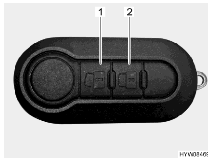
Fig. 49 Mando a distancia del cierre centralizado (2 teclas)
