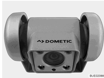
Fig. 20 Cámara de marcha atrás con LED infrarrojos
