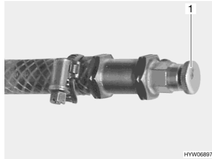
Fig. 310 Válvula de purga de la calefacción de agua caliente
