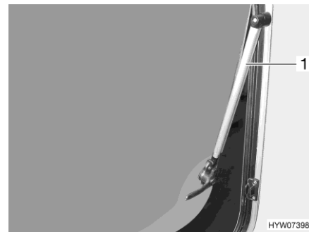
Fig. 100 Ventana abatible con soporte automático
