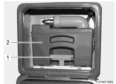
Afb. 304 Fecaliëntank (voorbeeld)
