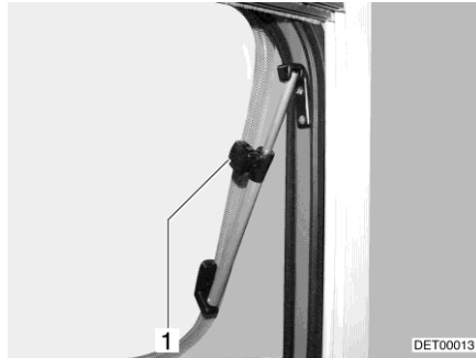
Afb. 123 Dakluik met draaibare uitzetters, geopend
