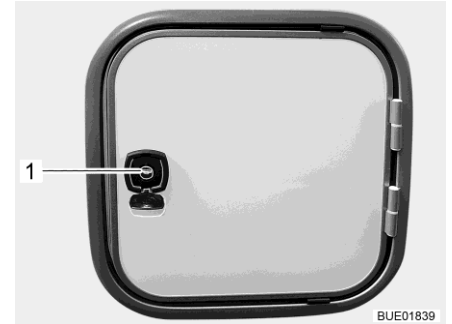
Afb. 302 Luik voor de fecaliëntank (alternatief)
