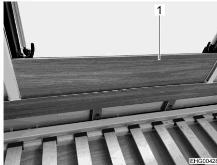
Kuva 188 Putoamissuoja (ikkuna)
