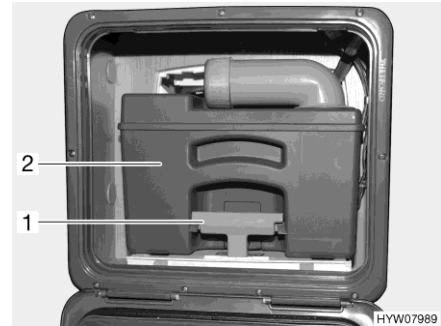
Kuva 292 Septitankki (esimerkki)
