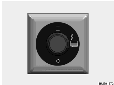
Kuva 287 Kytkin jäteveden lämmitykselle
