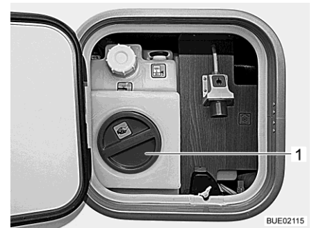
Kuva 307 Vesisäiliön puhdistusaukko (huoltoyksikkö)
