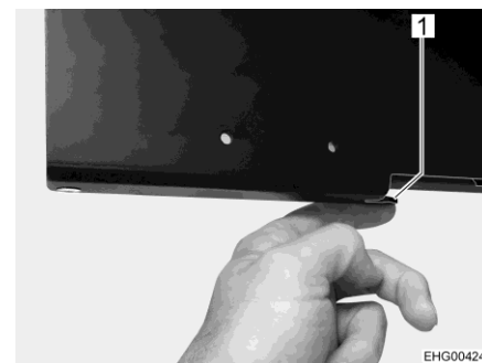
Kuva 96 Kääntömekanismin lukituksen avaaminen
