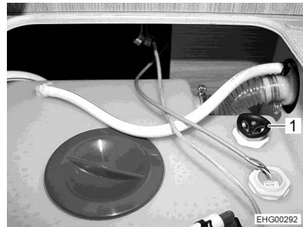
Kuva 276 Vesisäiliö (vaihtoehtoinen)
