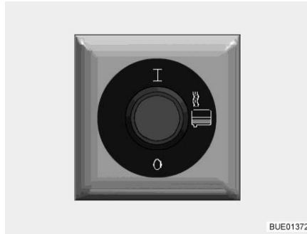
Kuva 283 Kytkin jäteveden lämmitykselle
