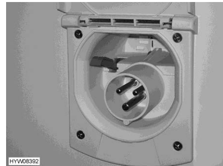
Kuva 194 230 V:n liitäntä ajoneuvossa (ilman huoltoyksikköä)
