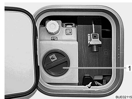
Kuva 303 Vesisäiliön puhdistusaukko (huoltoyksikkö)
