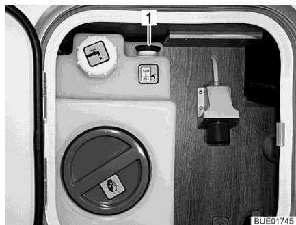
Fig. 273 Serbatoio dell'acqua (unità di servizio)
