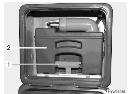
Fig. 288 Serbatoio fecale (esempio)
