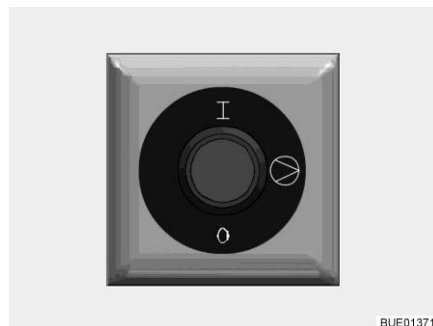
Fig. 229 Interruttore di comando pompa di circolazione aggiuntiva
