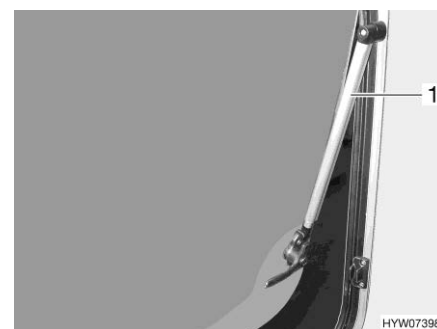
Fig. 96 Finestra apribile con deflettore automatico
