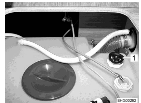
Fig. 274 Serbatoio dell'acqua (alternativa)
