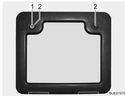
Afb. 299 Luik voor de fecaliëntank (alternatief)
