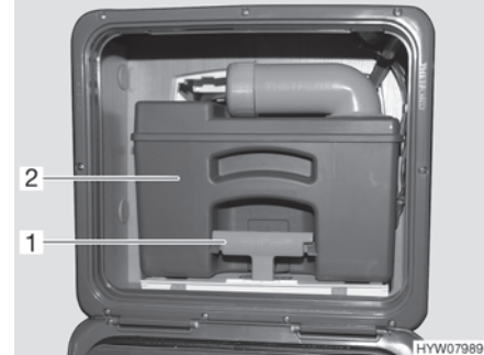
Fig. 181 Depósito de aguas fecales
