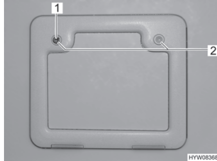
Fig. 180 Trampilla para el depósito de aguas fecales
