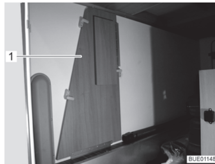
Fig. 11 Ensanchamiento de cama en el garaje trasero
