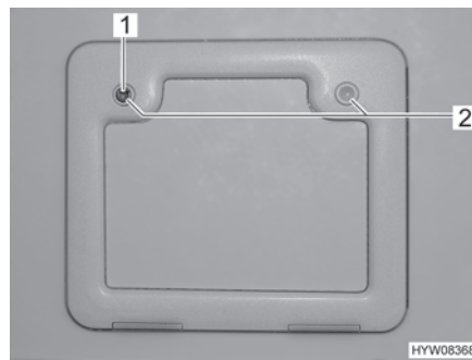
Fig. 174 Trampilla para el depósito de aguas fecales
