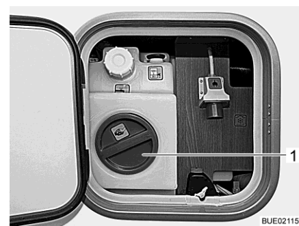
Bild 278 Rengöringsöppning på vattentanken (serviceenhet)
