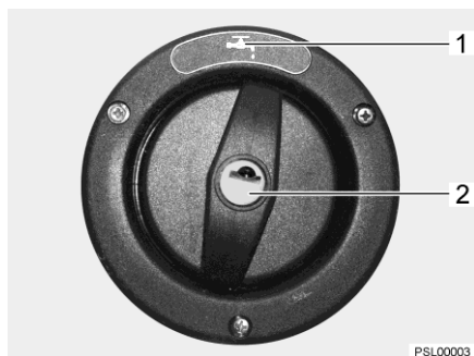
Bild 246 Påfyllningsöppning för dricksvatten (Lyseo I)
