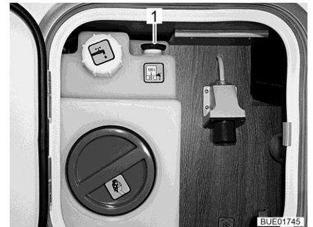
Bild 253 Vattentank med ratt i serviceenhet
