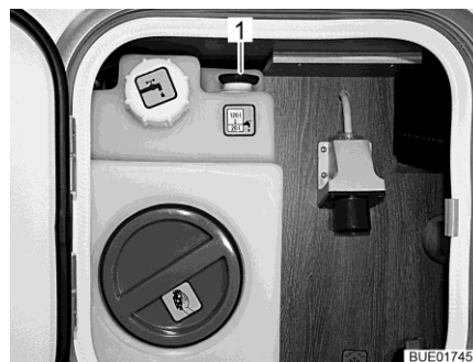
Bild 255 Vattentank med ratt i serviceenhet
