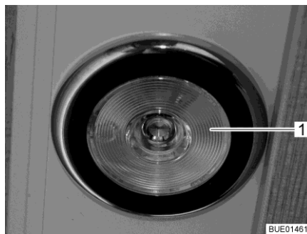
Bild 101 Infälld lampa, ljusbrytare i lampan
