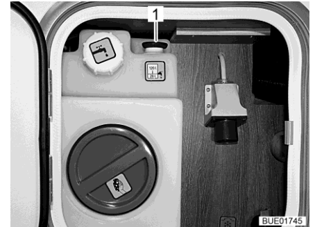
Kuva 253 Vesisäiliö kääntökahvalla huoltoyksikössä
