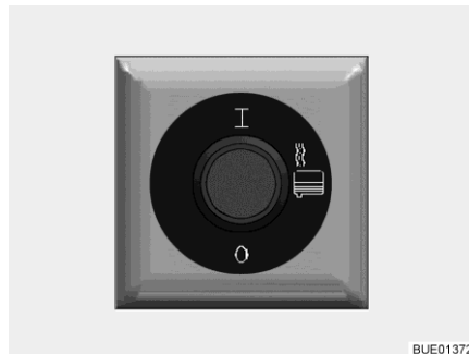
Kuva 262 Kytkin jäteveden lämmitykselle
