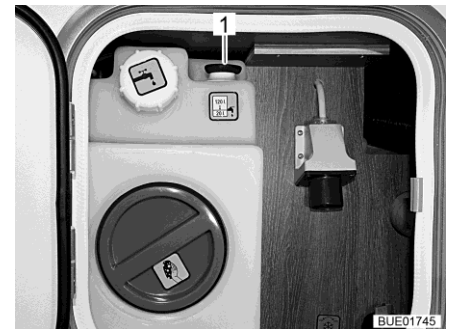
Kuva 255 Vesisäiliö kääntökahvalla huoltoyksikössä
