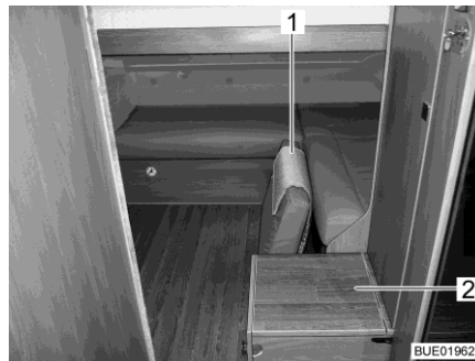
Kuva 146 Tavaratila ja irrotettu selkänöjan tyyny
