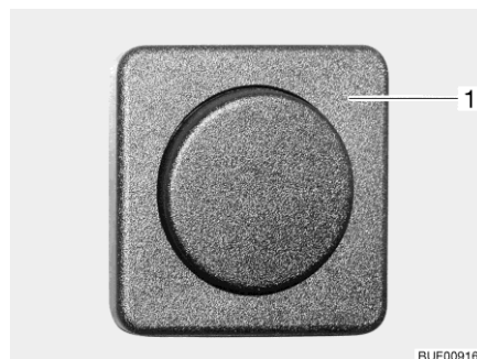
Afb. 77 Schakelaar, gescheiden van de lamp (voorbeeld)
