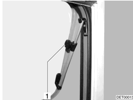
Bild 115 Tacklucka med vridspärrar, öppen
