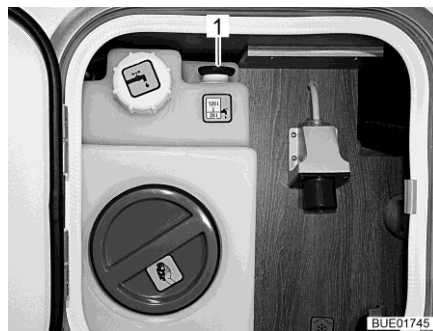
Bild 266 Vattentank (central försörjningsenhet)
