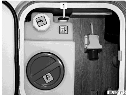
Fig. 265 Depósito de agua (unidad de alimentación centralizada)
