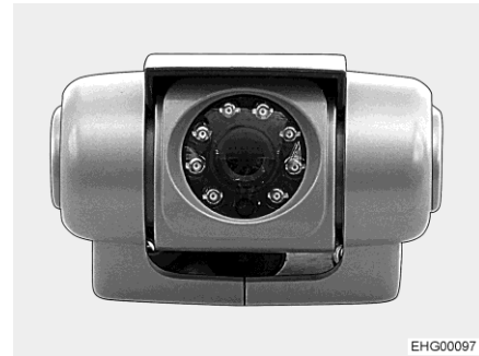
Fig. 22 Cámara de marcha atrás con LED infrarrojos (alternativa)
