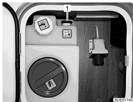
Fig. 266 Depósito de agua (unidad de alimentación centralizada)
