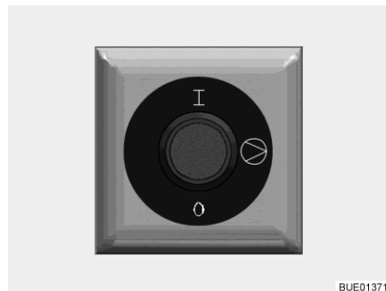
Fig. 222 Conmutador de mando de la bomba de circulación adicional
