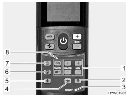
Fig. 230 Mando a distancia con teclas de ajuste (instalación de aire acondicionado)
