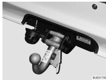
Bild 8 Anhängerkupplung, abnehmbar
