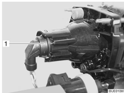
Bild 216 Abblendlicht/Fernlicht/Standlicht
