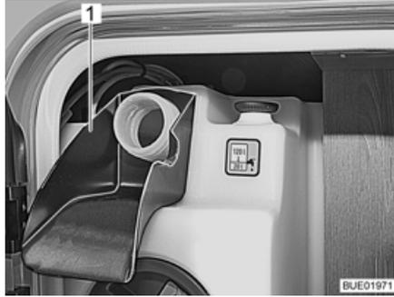
Bild 191 Einfüllhilfe
