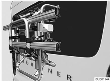
Bild 2 Fahrradträger, nach oben geklappt
