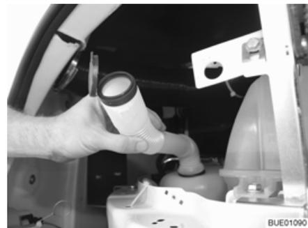
Bild 43 Einfüllstutzen in Füllposition
