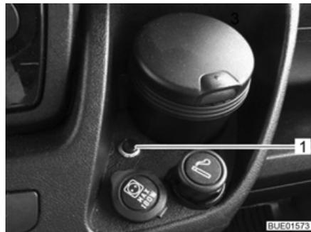
Bild 50 Drucktaster zur Aktivierung der Fernsteuerung
