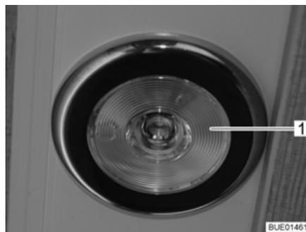
Bild 84 Einbauleuchte, Lichtschalter in der Leuchte
