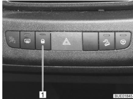
Bild 60 Schalter Zentralverriegelung
