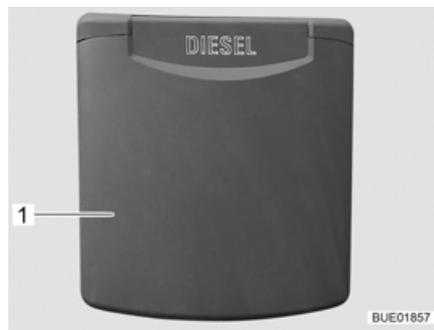
Bild 44 Außenklappe Kraftstoff-Einfüllstutzen
