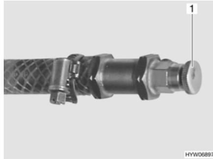
Bild 213 Entlüftungsventil Warmwasser-Heizung
