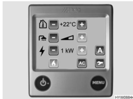
Bild 157 Einstellmenü (Bedieneinheit)
