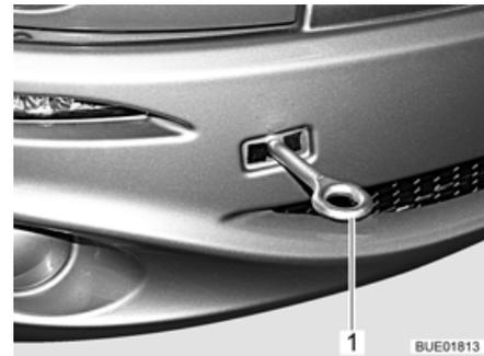
Bild 47 Abschleppöse, montiert
