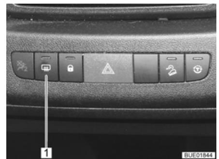
Bild 35 Schalter Außenspiegelheizung
