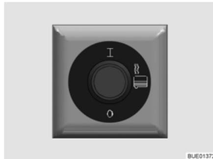
Bild 198 Schalter für Abwasserheizung
