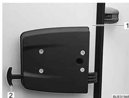
Bild 67 Notentriegelung Garagenklappe
