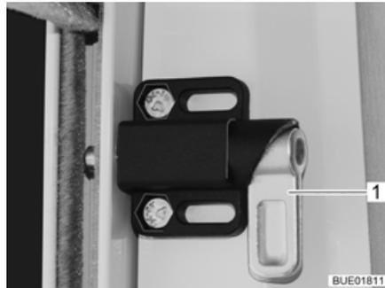
Bild 103 Sicherungsriegel Frontscheibenverdunklung
