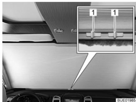
Bild 102 Manuelle Frontscheibenverdunklung, geschlossen
