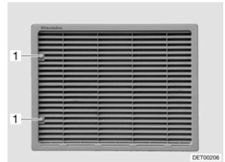
Bild 182 Kühlschrank-Lüftungsgitter (mit Schraube)
