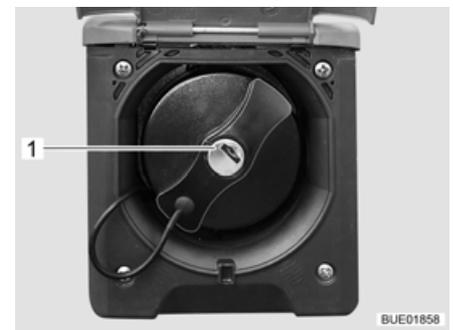
Bild 45 Verschlussdeckel für Kraftstoff-Einfüllstutzen
