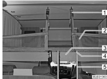
Bild 122 Hubbett mit aufgespanntem Sicherungsnetz
