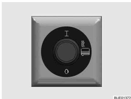
Fig. 250 Interrupteur pour le chauffage des eaux usées
