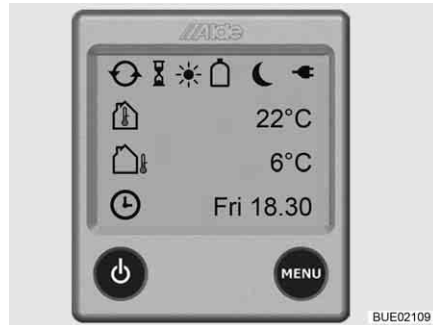
Fig. 195 Écran de démarrage (unité de commande)
