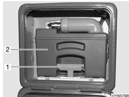
Fig. 263 Réservoir pour matières fécales (exemple)
