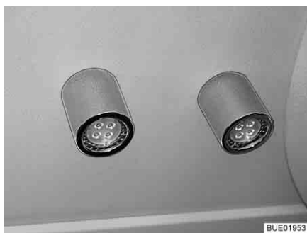
Fig. 67 Plafonnier, séparé de l'interrupteur (exemple)
