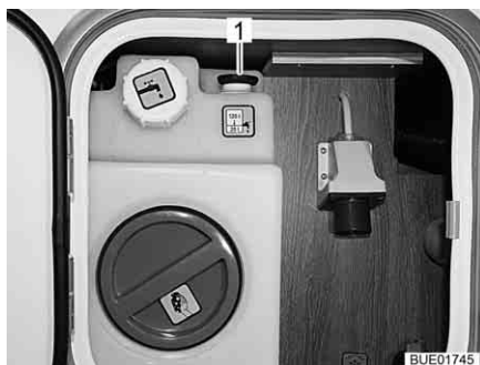
Fig. 243 Réservoir d'eau (unité d'alimentation centrale)
