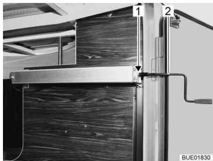
Fig. 118 Manivelle dans le garage arrière
