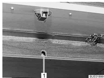
Fig. 128 Accès à l'entraînement (alternative)
