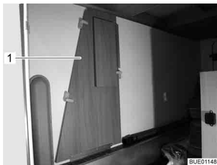
Fig. 13 Allargamento letto nel garage di coda
