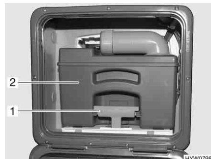
Fig. 263 Serbatoio fecale (esempio)
