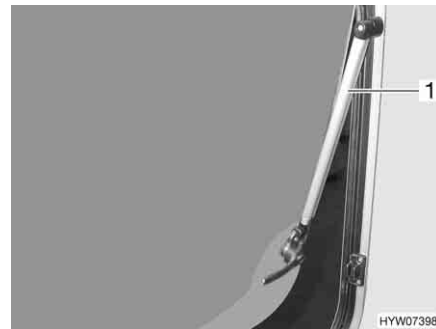
Afb. 82 Uitzetbaar raam met automatische uitzetters
