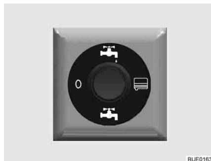
Bild 170 Brytare för elmanövrerad avtappningskran
