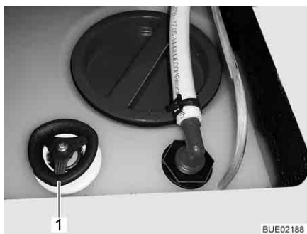
Bild 166 Vattentank med ratt
