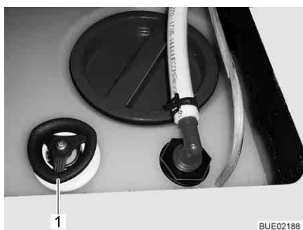
Bild 167 Vattentank med ratt
