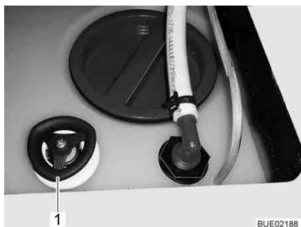
Bild 182 Vattentank med ratt
