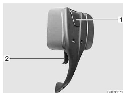
Fig. 42 Serrure de la porte cellule, à l'intérieur, verrouillée
