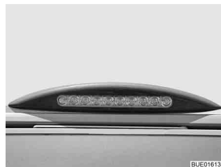
Fig. 60 Eclairage de l'auvent
