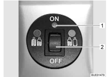
Afb. 94 Bedieningspaneel met afstandsindicatie
