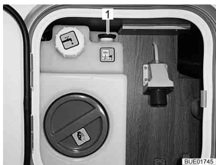
Bild 209 Vattentank (central försörjningsenhet)
