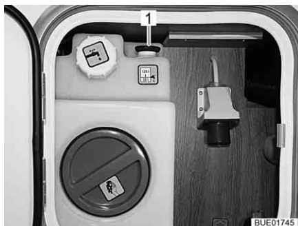
Bild 210 Vattentank (central försörjningsenhet)
