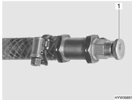
Bild 270 Entlüftungsventil Warmwasser-Heizung
