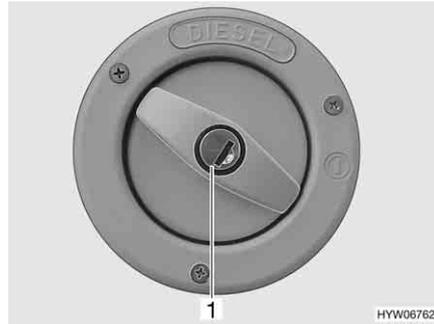
Bild 43 Verschlussdeckel für Kraftstoff-Einfüllstutzen
