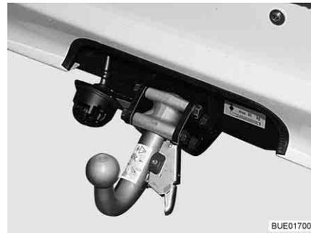
Bild 10 Anhängerkupplung, abnehmbar
