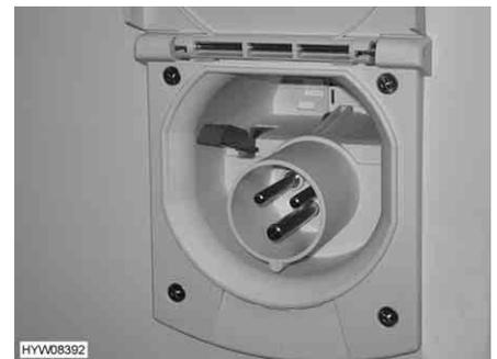
Bild 164 230-V-Anschluss am Fahrzeug
