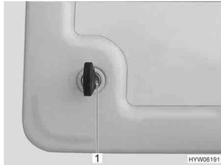
Bild 64 Druckschloss Serviceklappe
