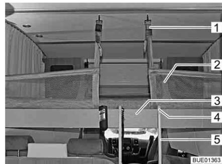
Bild 131 Hubbett mit aufgespanntem Sicherungsnetz
