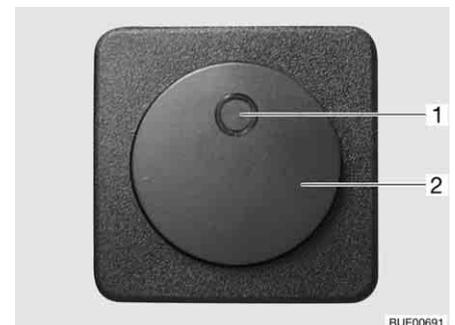
Bild 203 Schalter für elektrische Fußbodenerwärmung
