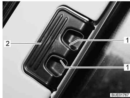
Bild 110 Verriegelung für Fahrer-/Beifahrerfenster
