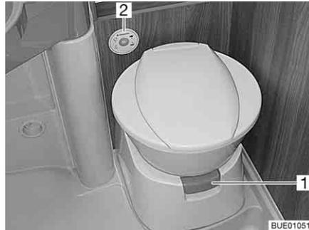
Bild 261 Toilettenschüssel mit Kontroll- und Bedieneinheit
