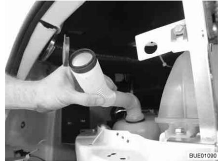
Bild 42 Einfüllstutzen in Füllposition
