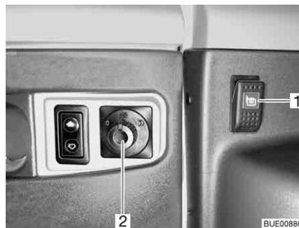
Bild 31 Schalter Außenspiegeleinstellung und Außenspiegelheizung
