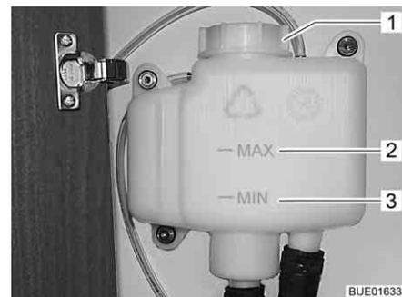
Bild 269 Ausgleichsbehälter ohne Blende
