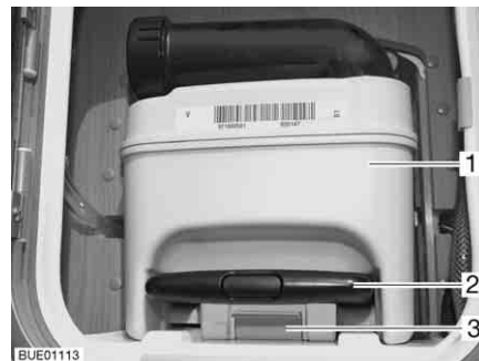
Fig. 165 Réservoir pour matières fécales
