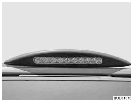
Fig. 43 Eclairage de l'auvent
