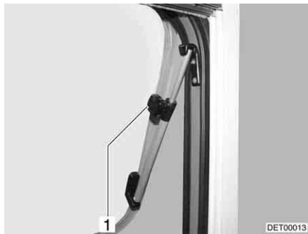
Kuva 99 Kattoluukku, jossa on kääntöpidikkeet, avattu
