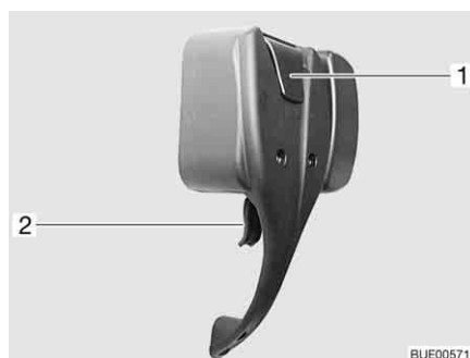
Kuva 44 Sisäänkäyntioven lukko, sisällä, lukittu
