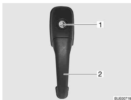
Kuva 43 Sisäänkäyntioven lukko, ulkoa
