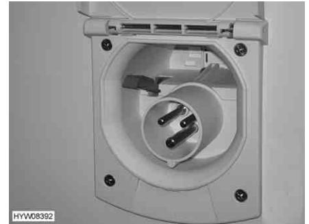
Fig. 143 Raccordement 230 V sur le véhicule
