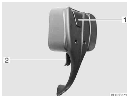
Fig. 44 Serrure de la porte cellule, à l'intérieur, verrouillée
