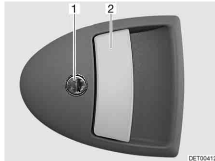
Fig. 45 Serrure de la porte cellule, à l'extérieur
