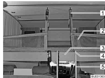
Bild 128 Hubbett mit aufgespanntem Sicherungsnetz
