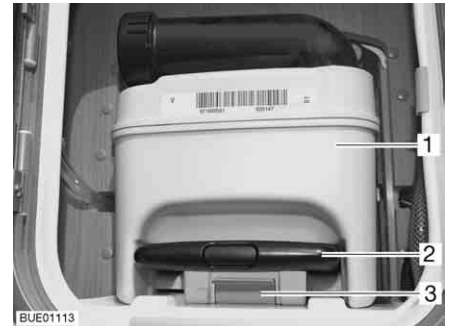
Fig. 240 Réservoir pour matières fécales
