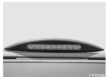
Fig. 78 Eclairage de l'auvent
