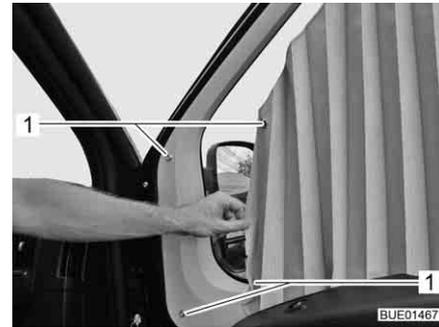
Bild 64 Befestigung Faltschirm
