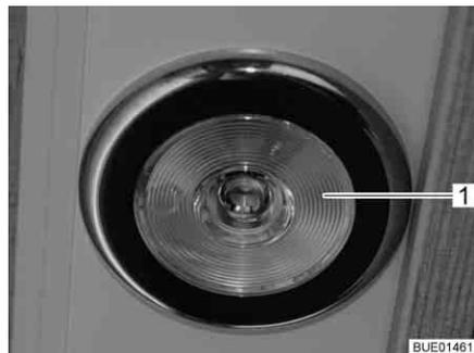
Bild 47 Einbauleuchte, Lichtschalter in der Leuchte
