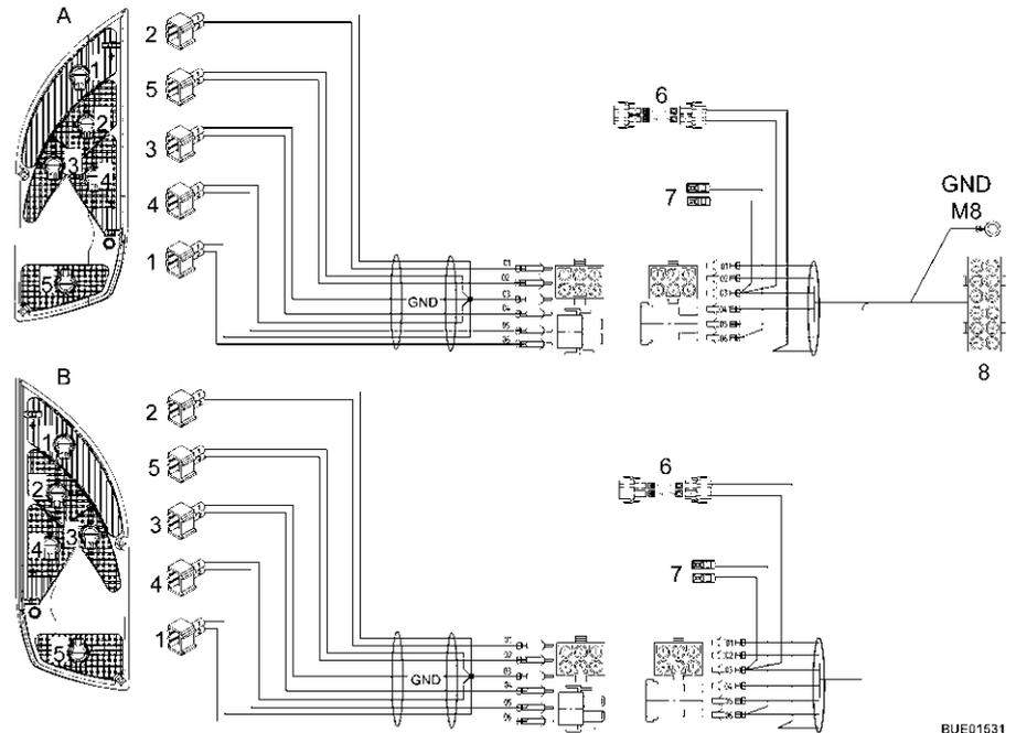
Bild 125 Stromlaufplan außen
