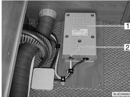
Bild 131 Trafo für elektrische Fußbodenheizung
