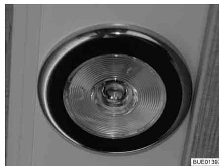
Bild 179 Einbauleuchte (Alternative)
