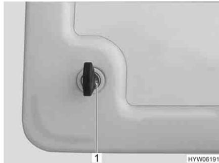
Bild 38 Druckschloss Serviceklappe
