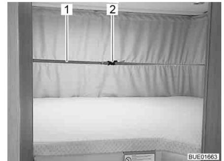
Bild 88 Hubbett mit geschlossenem Spannband
