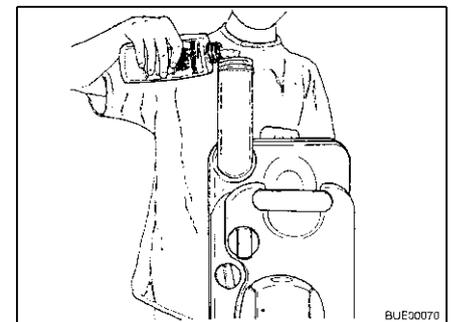
Bild 163 Sanitärflüssigkeit einfüllen
