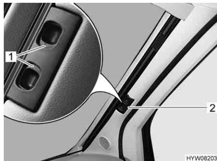
Bild 23 faltverdunklung für die Frontscheibe
