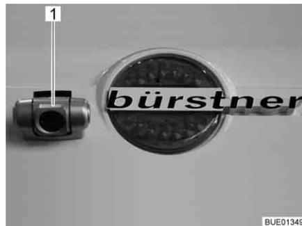
Bild 12 Rückfahrkamera mit Infrarotbeleuchtung (Waeco)
