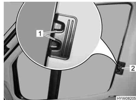
Bild 24 faltverdunklung für Fahrer-/Beifahrerfenster
