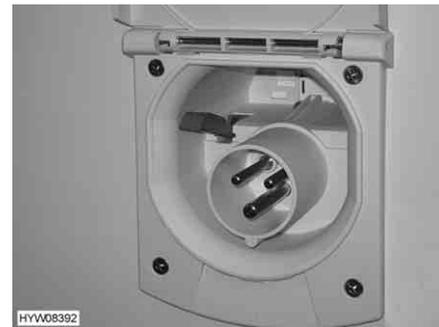
Bild 110 230-V-Anschluss am Fahrzeug
