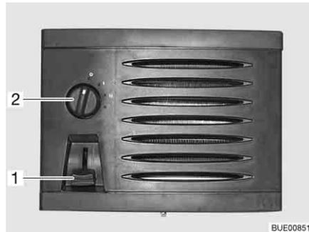
Bild 130 Bedienelemente Zusatz-Wärmetauscher
