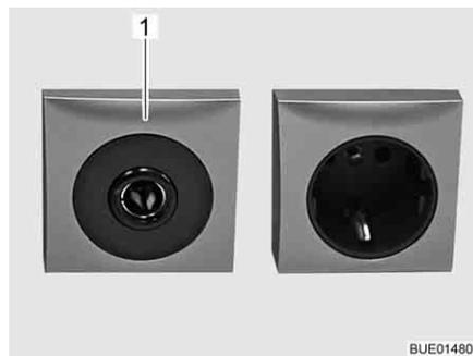
Fig. 103 Presa a 12 V/10 A
