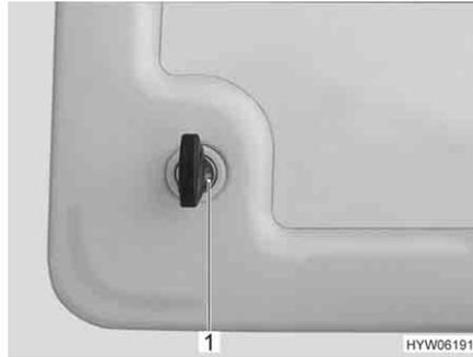
Fig. 38 Serratura a pressione sportello di servizio
