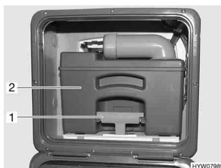
Fig. 173 Serbatoio fecale
