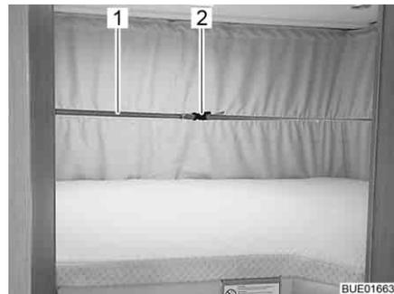
Fig. 88 Letto basculante con nastro tenditore chiuso
