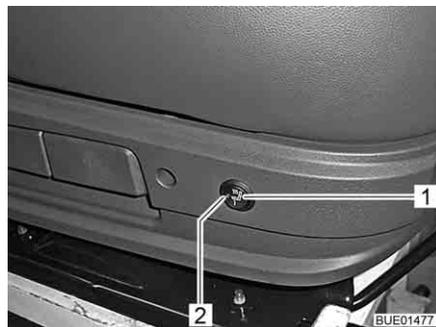
Fig. 17 Interruttore per riscaldamento del sedile
