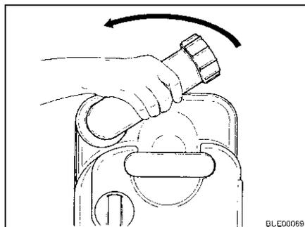
Fig. 162 Ruotare il bocchettone di scarico
