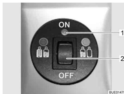
Fig. 101 Centralina di controllo con visualizzatore a distanza
