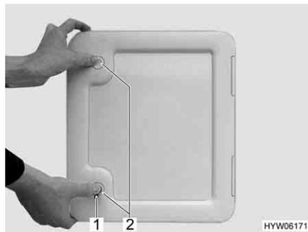
Fig. 160 Sportello per il serbatoio fecale
