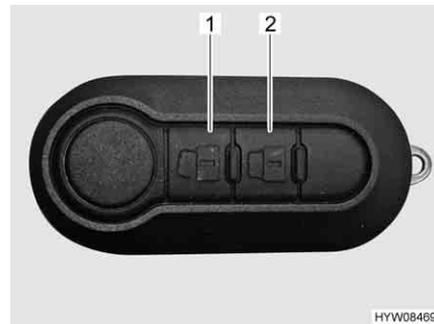
Fig. 28 Telecomando chiusura centralizzata
