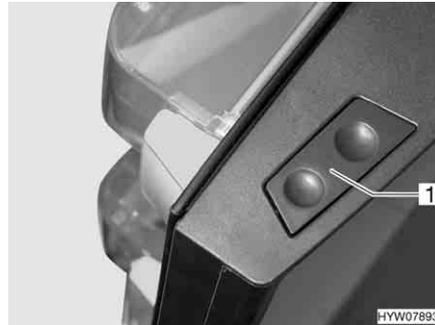
Fig. 145 Tasto di sblocco della porta del frigorifero (serie Dometic 8)
