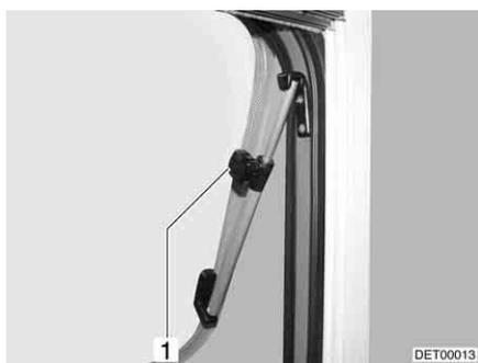
Fig. 54 Finestra apribile con deflettore a rotazione
