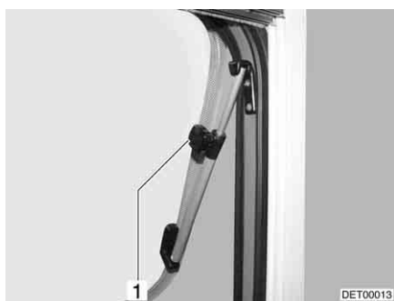
Billede 54 Ventilationsrude med drejeudskyder
