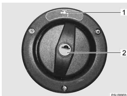
Billede 149 Dæksel til drikkevands-påfyldningsstuds
