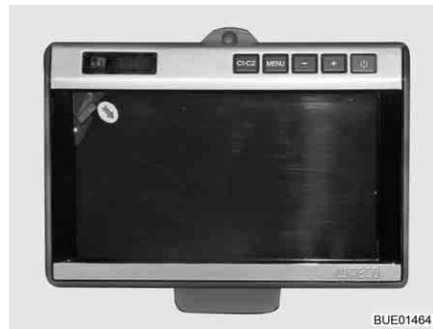
Billede 14 LCD-monitor til bakkamera (Waeco)
