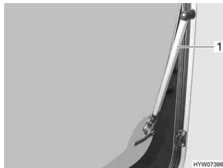
Billede 59 Ventilationsrude med automatiske udskydere
