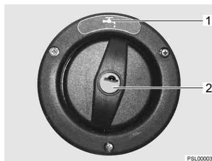
Billede 40 Dæksel til drikkevands-påfyldningsstuds
