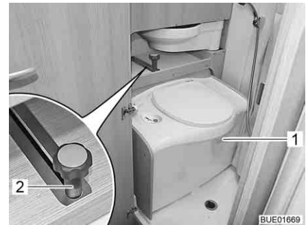
Billede 169 Toilet, trukket ud
