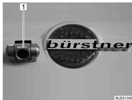
Billede 12 Bakkamera med infrarødt lys (Waeco)
