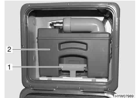
Fig. 173 Depósito de aguas fecales
