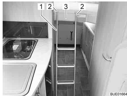
Fig. 89 Escalera de ascenso
