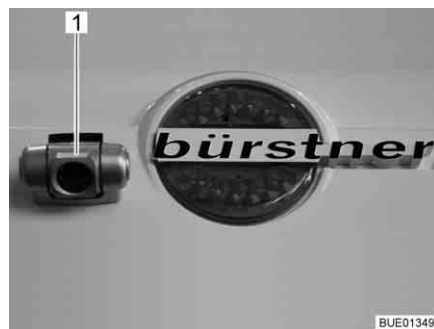
Bild 12 Backningskamera med infraröd belysning (Waeco)
