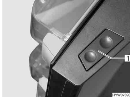
Bild 145 Frigöringsknapp till kylskåpsdörr (Dometic 8-serie)
