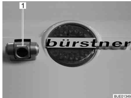
Afb. 12 Achteruitrijcamera met infraroodverlichting (Waeco)
