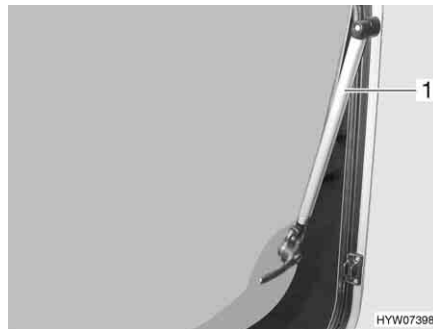
Afb. 59 Uitzetbaar raam met automatische uitzetters
