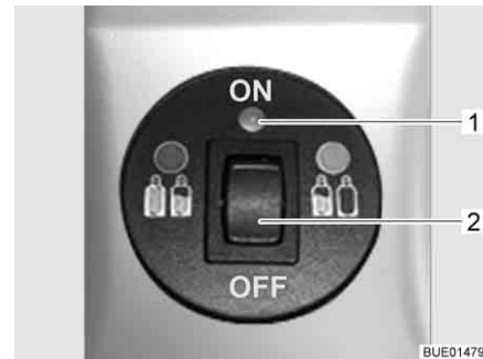
Afb. 101 Bedieningspaneel met afstandsindicatie
