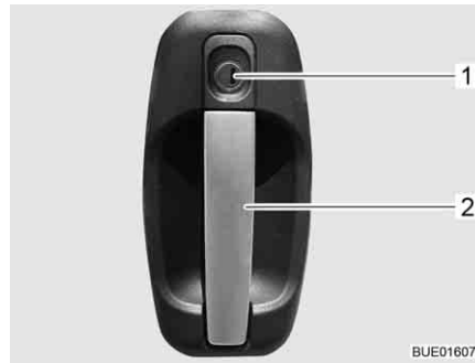
Kuva 57 Sisäänkäyntioven lukko, ulkoa
