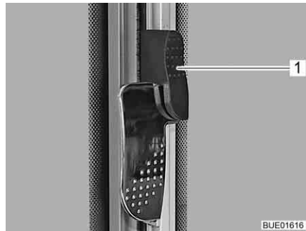
Kuva 103 Liukuikkunat kääntösalpauksella (lukittu)
