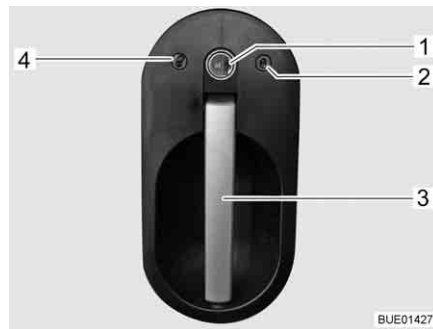
Kuva 55 Kuljettajan oven lukko, ulkoa
