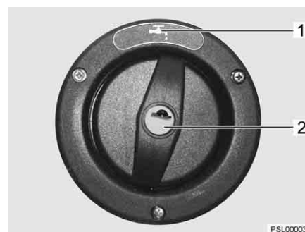
Kuva 55 Juomavesisäiliön täyttöaukon korkki
