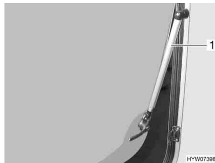
Kuva 78 Avattavat ikkunat, joissa on automaattipidikkeet
