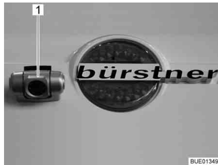
Bild 22 Backningskamera med infraröd belysning (Waeco)
