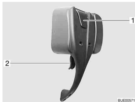
Bild 45 Dörrlås ingångsdörr, insida, låst
