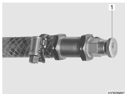
Billede 265 Udluftningsventil varmtvandsvarmeovn
