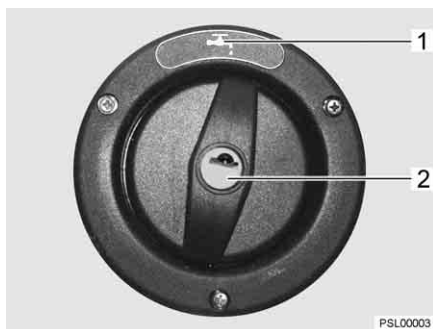
Billede 55 Dæksel til drikkevands-påfyldningsstuds
