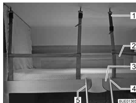
Billede 116 Hejseseng med opspændt sikkerhedsnet
