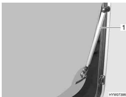
Billede 78 Ventilationsrude med automatiske udskydere
