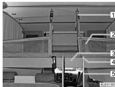
Billede 118 Hejseseng med opspændt sikkerhedsnet
