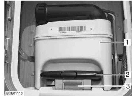
Fig. 249 Réservoir pour matières fécales
