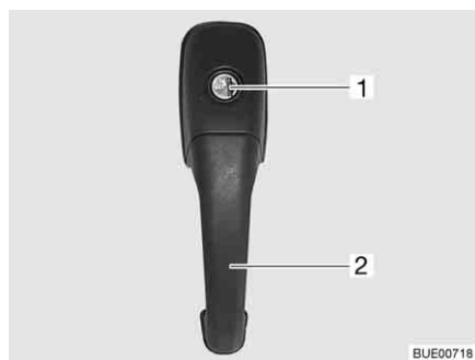
Fig. 44 Serrure de la porte cellule, à l'extérieur
