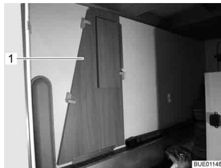
Fig. 17 Rallonge latérale de lit dans le garage arrière
