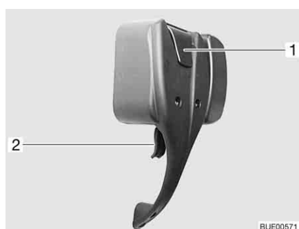
Fig. 45 Serrure de la porte cellule, à l'intérieur, verrouillée
