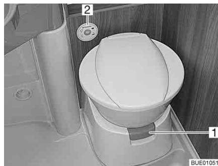
Fig. 258 Bacia sanitária com unidade de controlo e de comando
