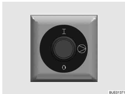
Fig. 203 Interruptor de comando da bomba de recirculação adicional
