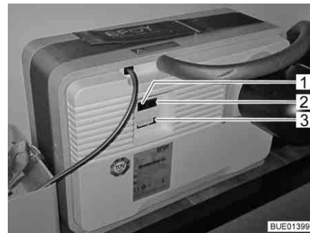
Fig. 169 Área de ligação do gerador 12 V
