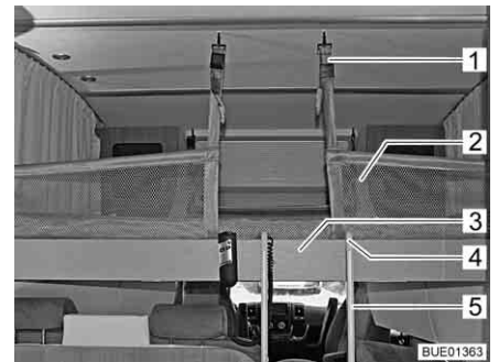
Fig. 118 Cama suspensa com rede de segurança instalada
