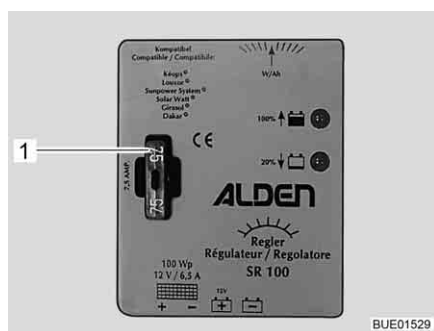
Fig. 170 Fusível do regulador de carga do painel solar 100 W
