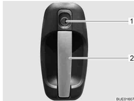
Fig. 57 Fechadura da porta de entrada, lado de fora
