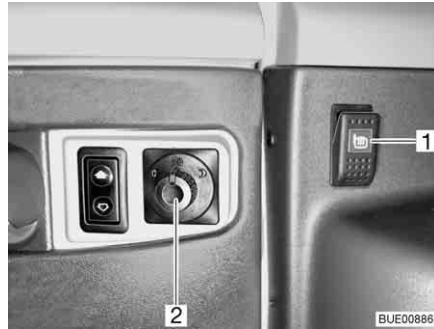
Fig. 32 Interruptor para regulação do espelho retrovisor externo e para o aquecimento do espelho retrovisor externo
