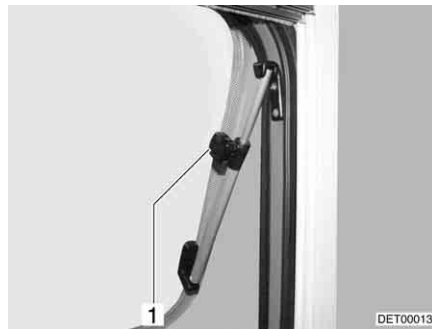
Fig. 94 Janela de projetar com defletor rotativo
