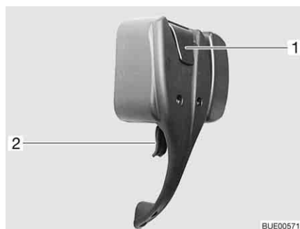
Bild 43 Dörrlås ingångsdörr, insida, låst
