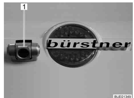
Bild 22 Backningskamera med infraröd belysning (Waeco)
