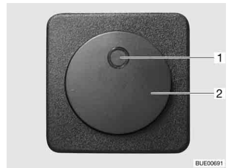
Bild 170 Brytare för elektrisk golvvärme
