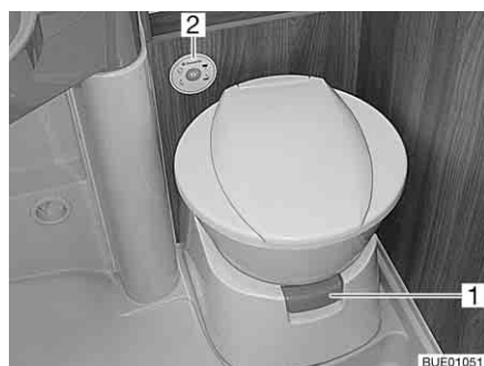
Bild 277 Toalettskål med kontrollenhet
