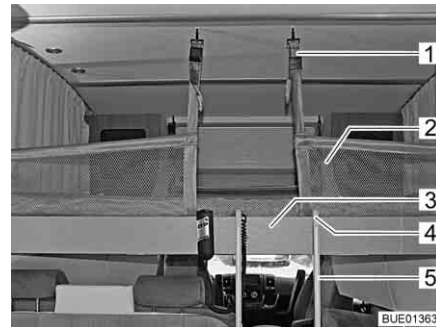
Bild 125 Höjbar säng med uppspant skyddsnet
