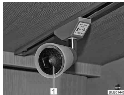
Bild 303 Sugkopp för lampbyte
