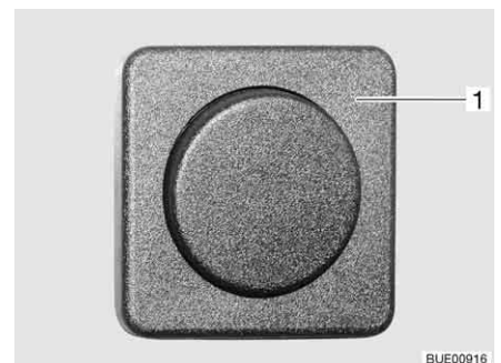
Afb. 42 Schakelaar, gescheiden van de lamp
