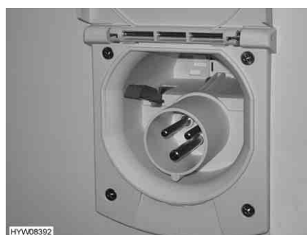
Afb. 90 230-V-aansluiting op het voertuig
