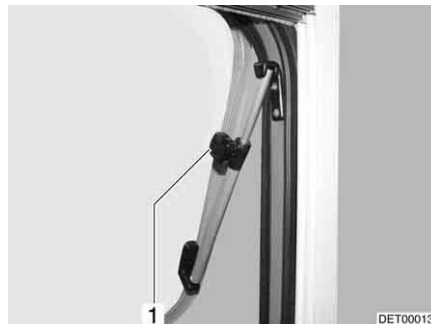
Afb. 48 Uitzetbaar raam met draaibare uitzetters, geopend
