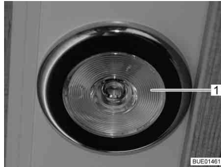
Bild 43 Infälld lampa, ljusbrytare i lampan
