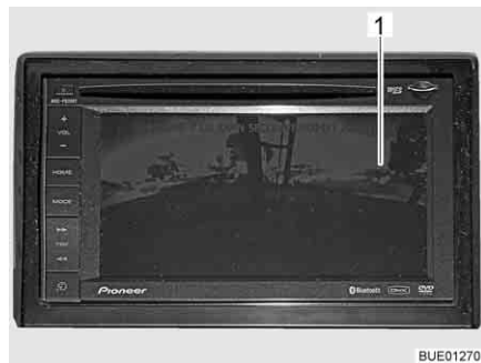
Fig. 23 Monitor LCD para la cámara de marcha atrás (Pioneer)
