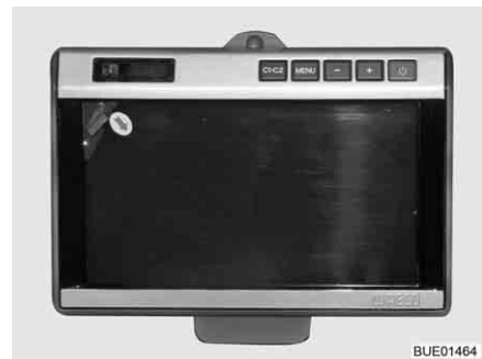
Fig. 24 Monitor LCD para la cámara de marcha atrás (Waeco)
