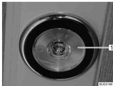
Fig. 60 Lámpara empotrada, interruptor de luz dentro de la lámpara
