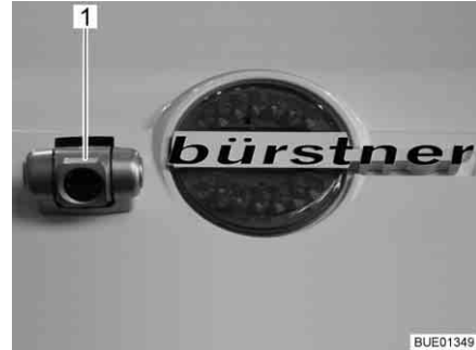
Fig. 22 Cámara de marcha atrás con iluminación infrarroja (Waeco)
