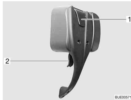
Fig. 42 Cerradura de la puerta de entrada, en el interior, bloqueada
