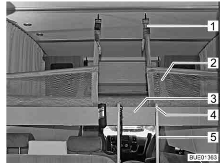
Fig. 115 Cama elevada con red de seguridad tendida
