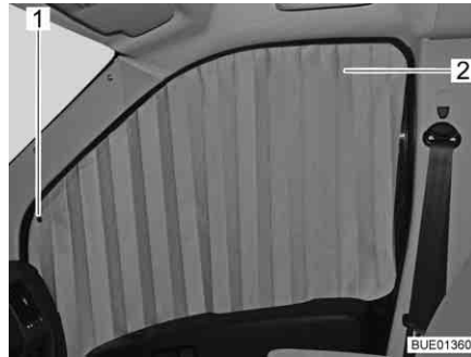
Fig. 80 Tendina plissettata sul finestrino del passeggero
