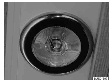
Fig. 298 Lampada a incasso (alternativa)
