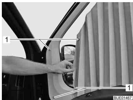
Fig. 29 Tendine oscuranti plissettate
