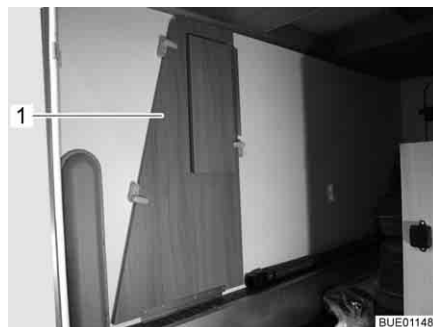
Fig. 17 Allargamento letto nel garage di coda
