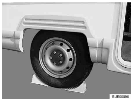
Fig. 308 Bloccare il veicolo
