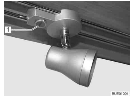
Fig. 58 Faretto, interruttore luci direttamente sulla lampada
