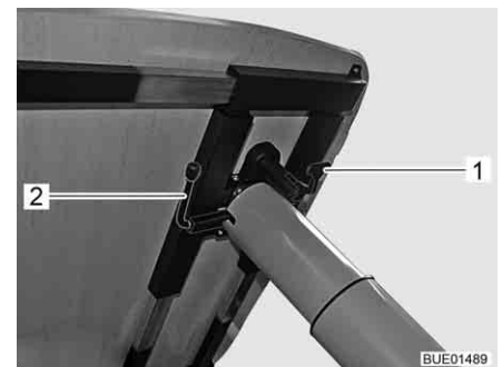
Fig. 104 Regolazione del tavolo rialzabile (alternativa)
