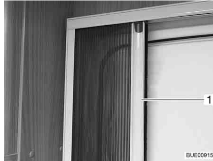
Fig. 46 Protezione contro gli insetti
