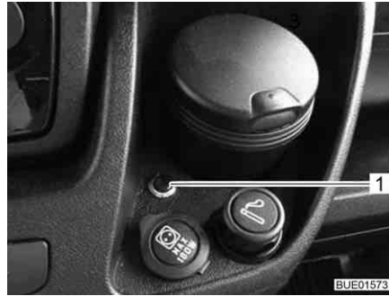
Fig. 35 Pulsante a pressione per l'attivazione del telecomando
