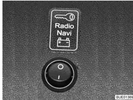
Fig. 169 Selettore della modalità operativa
