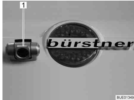
Fig. 16 Caméra de marche arrière avec éclairage à infrarouge (Waeco)
