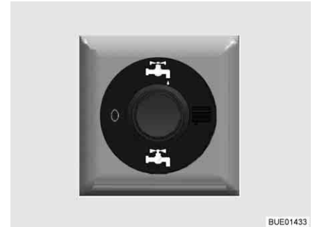
Fig. 237 Commutateur de commande du robinet de vidange à commande électrique (équipement spécial)
