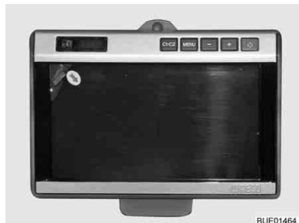
Fig. 18 Moniteur ACL pour caméra de marche arrière (Waeco)
