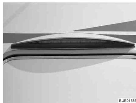
Fig. 73 Eclairage de l'auvent
