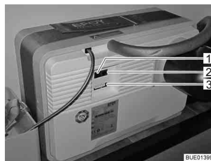
Fig. 161 Champ de raccordement de la pile à combustible
