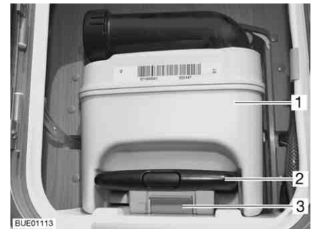
Fig. 274 Réservoir pour matières fécales
