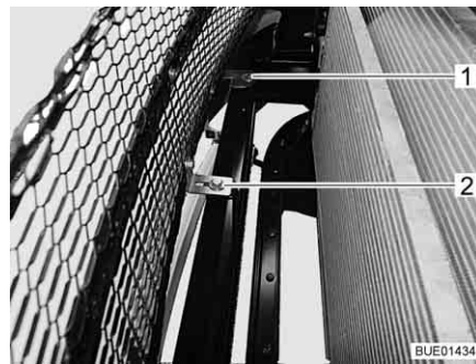
Fig. 290 Fixation du bloc avant en plastique
