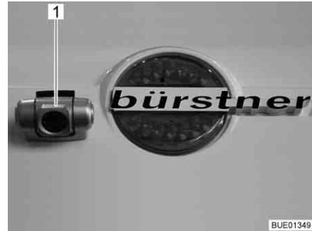
Fig. 20 Telecamera retromarcia con luce a infrarossi
