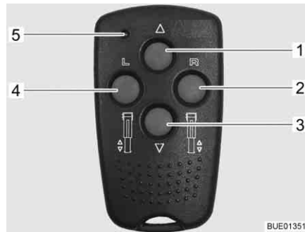
Fig. 29 Telecomando per piedini di stazionamento elettrici
