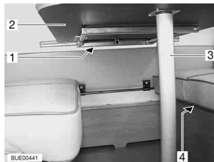
Fig. 88 Trasformazione in struttura di supporto letto
