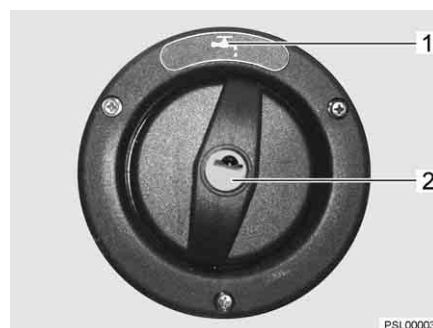
Fig. 178 Coperchio per bocchettone di riempimento dell'acqua potabile (alternativa)
