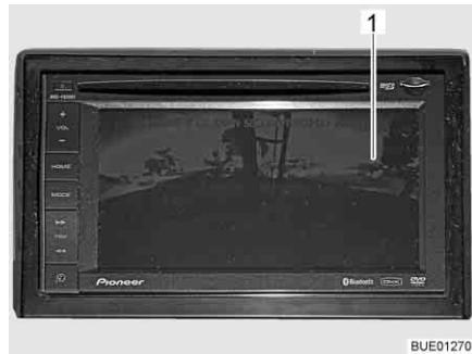
Fig. 21 Display LCD per telecamera retromarcia (esempio)
