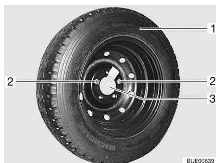
Fig. 240 Supporto per la ruota di scorta nel garage di coda
