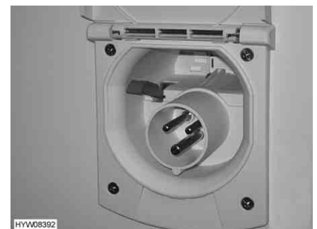
Fig. 124 Collegamento a 230 V sul veicolo
