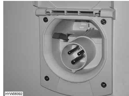
Afb. 124 230-V-aansluiting op het voertuig
